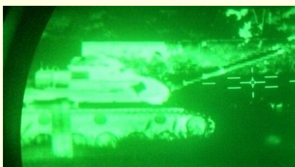
Figura 6: Visão "White Hot", Zoom de 8X (Pintura Original)
